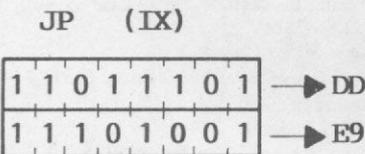
Descrição: O Program Counter (PC) é carregado com o conteúdo dos pares de registradores IX ou IY. A próxima instrução executada pelo microprocessador encontra-se no endereço de memória contido no par de registradores indexados IX ou IY.
